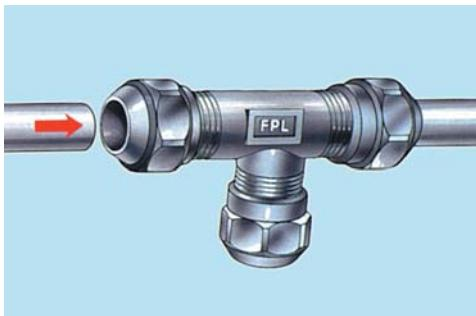
2. Das Rohrende bis zum Anschlag in das Kupplungsstück einschieben und Druckmutter von Hand festdrehen.
