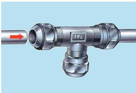
2. Enfoncer l'extrémité du tube dans le raccord jusqu'à la butée puis visser l'écrou à la main.
