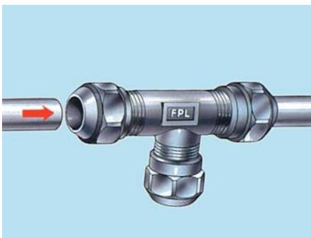
2. Rørenden føres ind i koblingen til stop, omløber spændes til med hånden.
