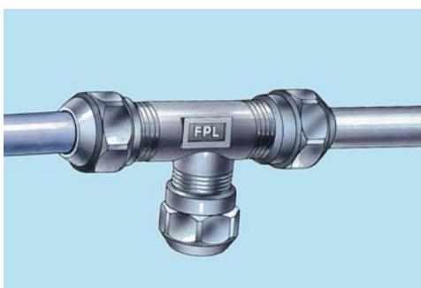
4. Die Klemmverbindung ist damit fertig. Auf Dichtheit kontrollieren und erforderlichenfalls nachziehen.
