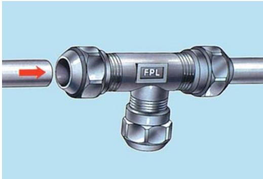
2. Rørenden stikkes inn i koblingen til stopp, deretter trekkes trykkmutteren til for hånd.
