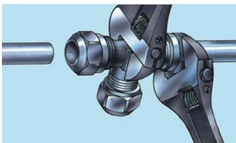
3. Die Druckmutter mit passendem Gabelschlüssel festziehen: Anzahl Umdrehungen - Bitte sehen Sie die Tabelle. Beim Festziehen wird der Konus in das Rohr eingepreßt, und eine einwandfreie Abdichtung hergestellt.
