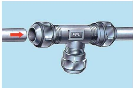
2. Putken pää työnnetään liittimessä olevaan pysäyttimeen saakka. Tämän jälkeen mutteri kiristetään käsin.
