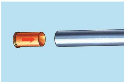
1. Kontrollieren, daß das Rohrende keinerlei Riefen, Grate oder andere Beschädigungen aufweist. Erforderlichenfalls Stützhülse in das Rohr einschieben.
