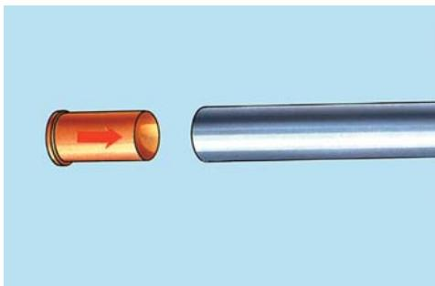
1. Vérifier la netteté de l'extrémité du tube qui doit être lisse, sans stries ni arêtes ou autres imperfections. Mettre au besoin la douille de renforcement dans le tube.
