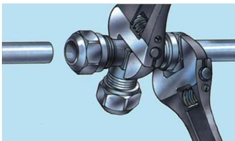
3. Serrer l'écrou à l'aide d'une clé à la dimension appropriée: No de tours - voir tableau. Ce qui a pour effet de presser l'olive contre le tube et d'en assurer l'étanchéité.
