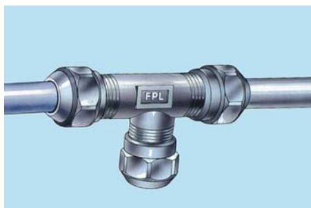
4. Liitos on valmis. Tarkista tiiveys ja tarvittaessa suorita jälkitiukennus. **Huom!** Älä käytä putkipihtejä äläkä käänä mutteria pohjaan.
