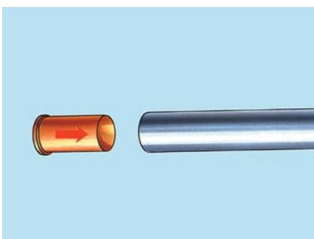
1. Efterse at rørenden er fri for ridser, grater eller andre skader. **OBS!** Støttebøsning placeres i røret.
