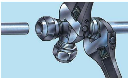
3. Trekk til trykkmutteren med nøkkel av passende størrelse. Antall omdreininger - se tabell. Konusen presses da mot røret og tetter.
