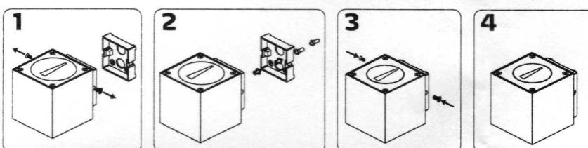
**Installation uden reflektor/ Installation utan reflektor/ Installation without reflector/ Montage ohne Reflektor/ Asennus ilman heijastinta**
