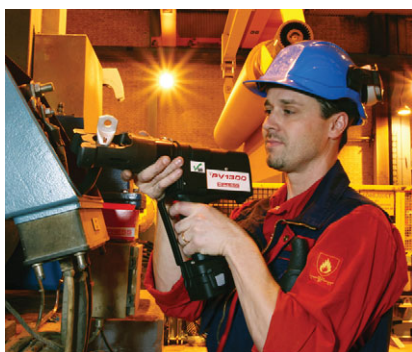
Kontaktpresning med presseværktøj PVL1300 i krævende industri applikation
