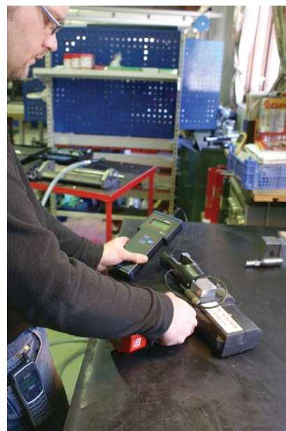
Kalibrering af presseværktøj PVL1300 på Elpress serviceafdeling
