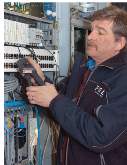
Elpress Mobile - et professionelt værktøj med udskiftelige bakker til installatøren eller serviceteknikeren
