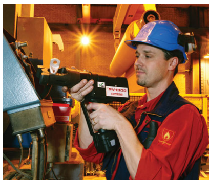
Kontaktpresning med Elpress batteridrevet presseværktøj PVL1300
